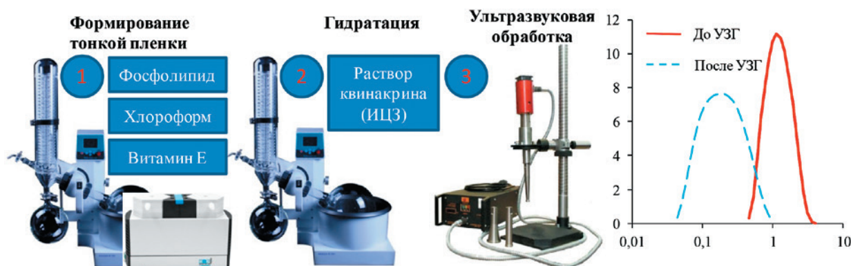
Рис. 1. Схема синтеза липосом с инкапсулированным квинакрином
