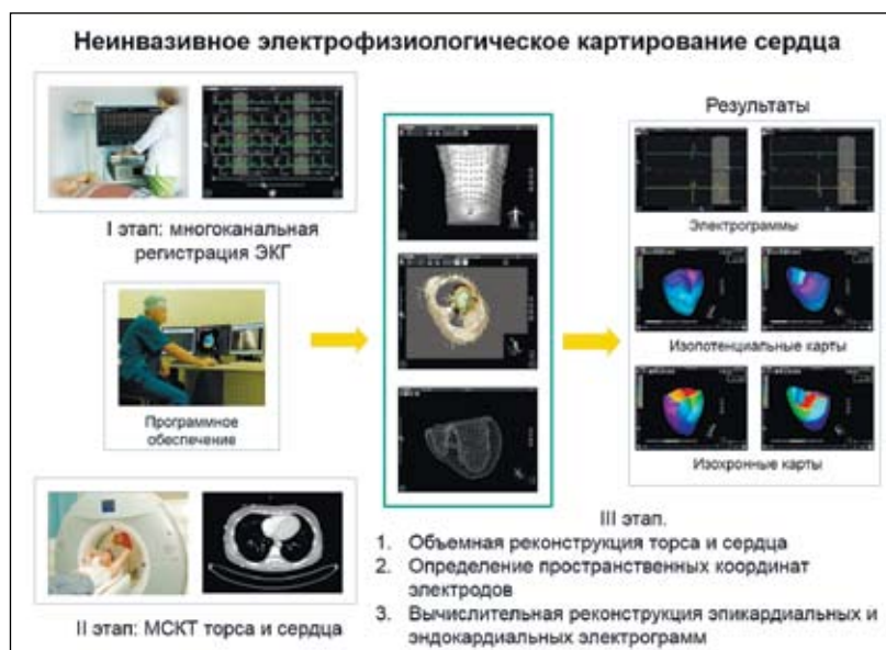
Рисунок 2. Схема неинвазивного электрофизиологического картирования сердца с использованием комплекса «Amucard 01C EP Lab»
