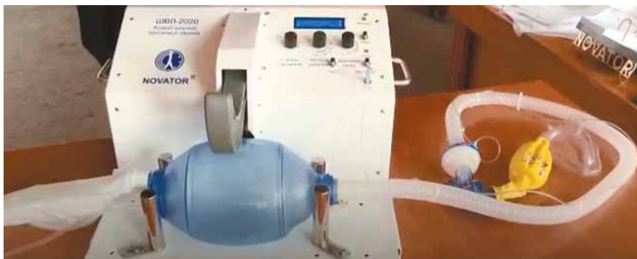
Рис. 1. Постельный аппарат ИВЛ, работающий на принципе объемного вытеснения газа из мешка
