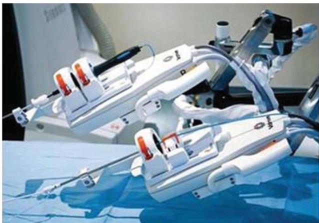
**Рисунок 2. Модуль Vdrive для удаленного манипулирования циркулярным катетером**
